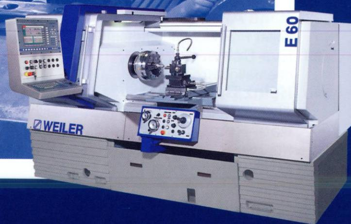
Zyklengesteuerte Präzisionsdrehmaschine E60
